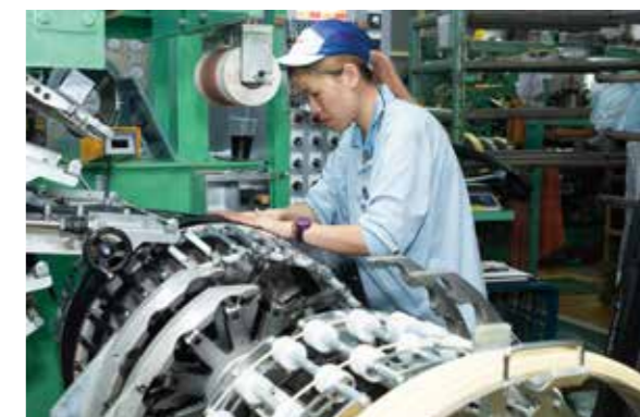
タイヤ製造は、機械化できることばかりではない。貼り付けたうえで必要な箇所を切り取るには、やはり人の手が欠かせない。
