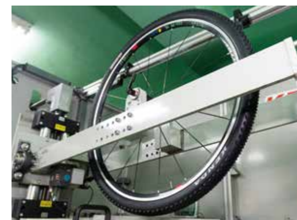
タイヤは、試作段階から異なる種類の検査が行われる。タイヤからの圧が着地面に均等にかかっているか、それがどれほど持続するかなど、細かな項目を確認する。
